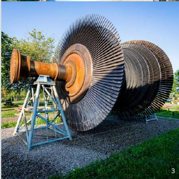
1. Roue de turbine (type Pelton) de la centrale hydraulique de Malgovert dans les Alpes - 2. Centrale photovoltaïque Smartflower - 3. Rotor de turbine à vapeur, provenant de la centrale nucléaire de Fessenheim - 4. Jeu des ampoules
